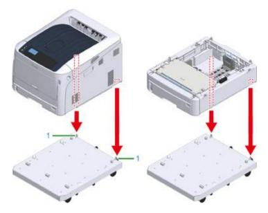
3 Прикрепите принтер или дополнительный лоток к подставке на роликах. На рисунке показан пример прикрепленного дополнительного лотка к подставке на роликах.
