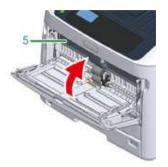
5 Протрите ролики подачи бумаги влажной тканью, которая была хорошо отжата.
