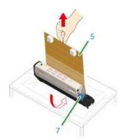
Установите фотобарабан с извлеченным защитным листом в принтер и поверните запирающий рычаг тонер-картриджа (7) (синий) в направлении стрелки таким образом, чтобы он совпадал с ▶.
