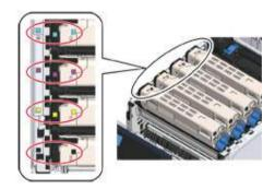
Поворачивайте рычаг блокировки (синий) тонер-картриджа (5) на себя до тех пор, пока его верхняя часть не совпадет с отметкой ▶, а затем отсоедините тонер-картридж от фотобарабана.
