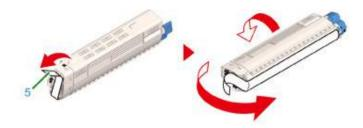
Установите новый картридж (6), совмещая выемку с левой стороны (7) с выступом (8) на фотобарабане таким образом, чтобы картридж был выровнен относительно наклейки с указанием цвета [К] на фотобарабане. Затем плотно зафиксируйте правый край.
