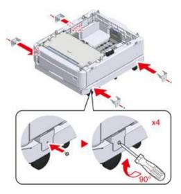
4 Совместите заднюю часть дополнительного лотка нижнего уровня с выступом на задней части дополнительного лотка, который необходимо установить, а затем осторожно подсоедините их.
