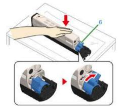
13 Проверьте метку с указанием цвета на новом фотобарабане и установите фотобарабан в устройство.
