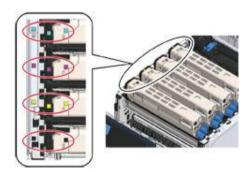
Извлеките фотобарабан (5) из устройства и разместите его на ровной поверхности.
