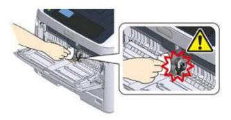
б Потяните крышку разделительного ролика (6) вперед, надавив на центральную часть МЦ лотка.
