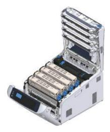
🙎 Закройте выходной лоток (4), надавив на центральную часть крышки.
