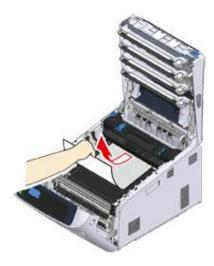
**б** Поднимите левый фиксирующий рычажок (5) блока термоэлемента в направлении вперед.
