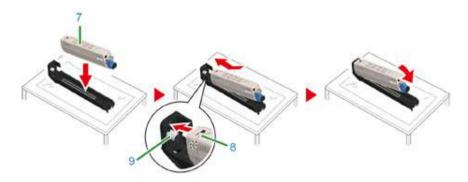
12 Поворачивайте рычаг блокировки (синий) тонер-картриджа (6) назад до тех пока, пока его верхняя часть не совпадет с отметкой ▶, одновременно прижимая картридж, а затем присоедините тонер-картридж к фотобарабану.
