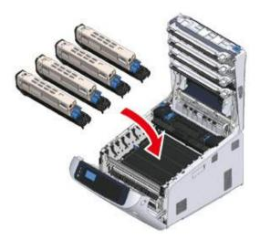
7 Закройте выходной лоток (4), надавив на центральную часть крышки.
