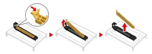
Установите картридж (7), извлеченный в ходе шага 7, совмещая выемку с левой стороны (8) с выступом (9) на фотобарабане таким образом, чтобы
