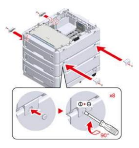
**6** Если установлено более двух дополнительных лотков, аккуратно разместите принтер сверху таким образом, чтобы задняя часть дополнительного лотка совпадала с задней частью принтера.
