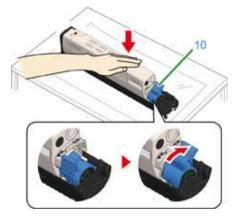
Проверьте метку с указанием цвета на новом фотобарабане и установите фотобарабан в устройство.
