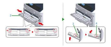
Таким же образом, нажимая на левый рычаг универсального лотка, слегка приподнимите универсальный лоток и закрепите лапку.
