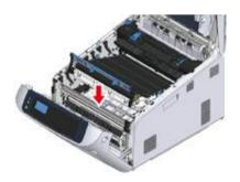
10 Поверните синие ручки (5) с обеих сторон блока ремня переноса в направлении стрелки, чтобы заблокировать его.
