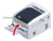
5 Для загрузки бумаги в универсальный лоток, поднимите крышку отсека для бумаги (1) и положите бумагу стороной для печати вверх.
