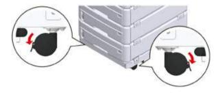
9 Если установлено более трех дополнительных лотков, извлеките детали, предохраняющие от опрокидывания, перед использованием принтера. Можно установить до четырех дополнительных лотков.
