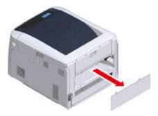
4 Убедитесь, что блок дуплексной печати расположен надлежащим образом, как показано на рисунке, а затем установите его в слот на задней стороне принтера.
