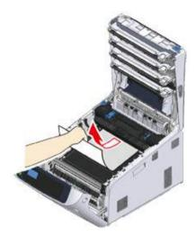
Осторожно извлеките замятую бумагу, приподняв освобождающие рычажки (5) на блоке термоэлемента, если край замятой бумаги не виден.
