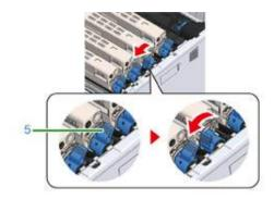
**6** Поднимите картридж (6) справа и извлеките его из устройства.
