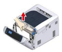
3 Извлеките блок дуплексной печати (3), потянув его наклонно вверх, удерживая за центральную выемку с задней стороны принтера.
