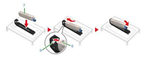
12 Поворачивайте рычаг блокировки (синий) тонер-картриджа (10) назад до тех пока, пока его верхняя часть не совпадет с отметкой ▶, одновременно прижимая картридж, а затем присоедините тонер-картридж к фотобарабану.
