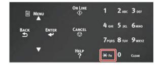
**2** Нажмите цифровые клавиши (0–9), чтобы отобразить нужный элемент функции, а затем нажмите кнопку ENTER (ВВОД).
