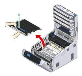
Удерживая новый блок ремня переноса за синюю рукоятку и поддерживая блок ремня переноса снизу, вставьте ось блока ремня переноса в паз (7) принтера.
