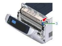
Поднимите тонер-картридж (4) справа и извлеките его из принтера.
