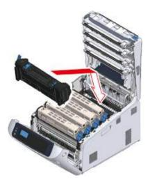
**10** Надавите назад на левый фиксирующий рычажок (5) блока термоэлемента, чтобы заблокировать его.
