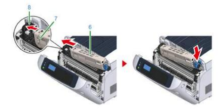
Прижимая тонер-картридж, поворачивайте рычаг блокировки (синий) тонер-картриджа (3) назад до тех пор, пока он не совпадет с отметкой ▶, а затем закрепите тонер-картридж на фотобарабане.
