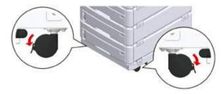
Если установлено более трех дополнительных лотков, извлеките детали, предохраняющие от опрокидывания, перед использованием устройства. Можно установить до четырех дополнительных лотков.
