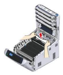
10 Держа блок термоэлемента за ручку (6), установите его в устройство.
