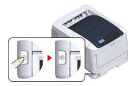
После включения принтера загорится индикатор на выключателе питания. Как только принтер будет готов к работе, на панели оператора отобразится сообщение «Готов к печати».
