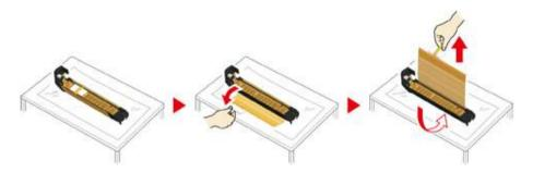
Снимите крышку тонера.
