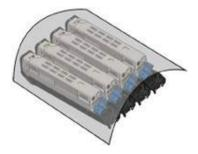
б Поверните синие ручки (5) с обеих сторон блока ремня переноса в направлении стрелки, чтобы разблокировать его.
