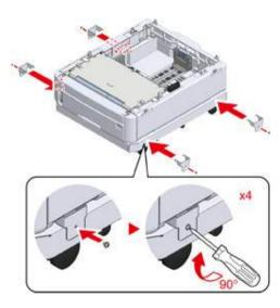
При установке еще одного дополнительного лотка аккуратно разместите лоток сверху таким образом, чтобы выступы сзади устанавливаемого дополнительного лотка совпадали с задней частью дополнительного лотка, который уже прикреплен к подставке на роликах.
