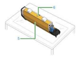
(2) Потяните защитный лист (5) в направлении стрелки. Не поворачивайте запирающий рычаг тонер-картриджа (7) (синий).
