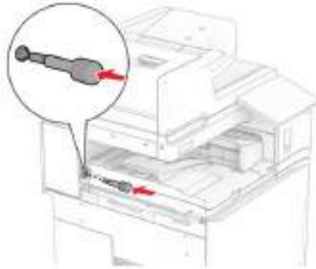
18 Откройте переднюю дверцу устройства, прикрепите накладку из комплекта модуля транспортировки бумаги к левой стороне МФУ и закройте дверцу.
