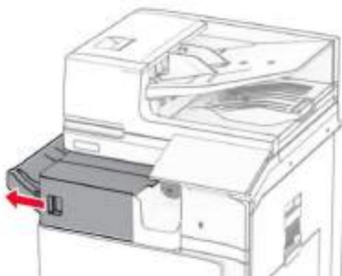
**3** Откройте дверцу в задней части степлера-финишера, а затем поверните ручку по часовой стрелке.
