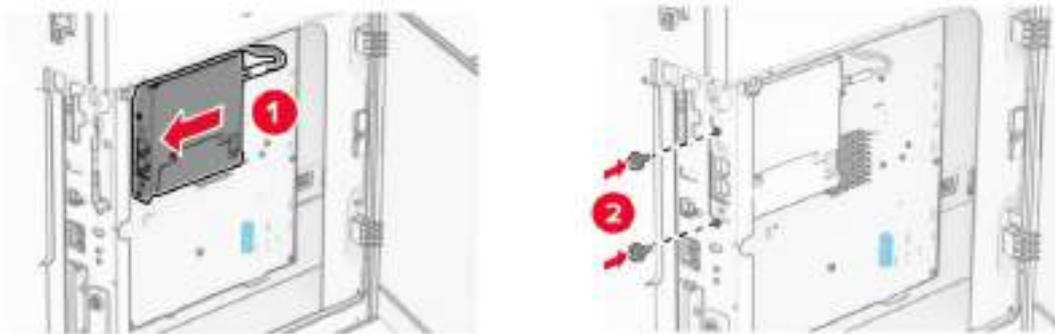
**8** Закройте крышку места установки платы факс-модема и зафиксируйте ее винтом.
