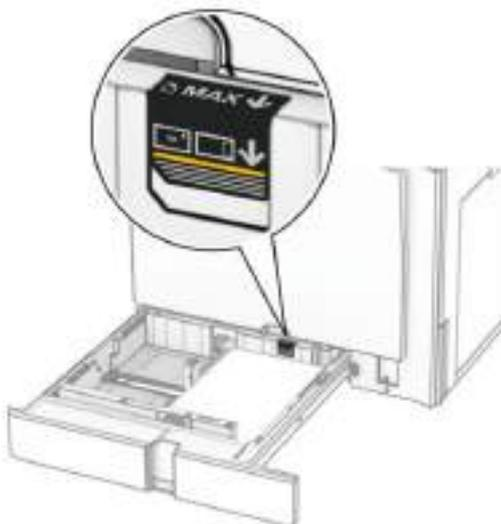
**5** Задвиньте лоток для размещения бумаги в устройство.
