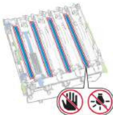
**5** Поместите блок формирования изображения на чистую плоскую поверхность фотобарабанами вверх, а затем разблокируйте на нем блок формирования монохромного изображения.
