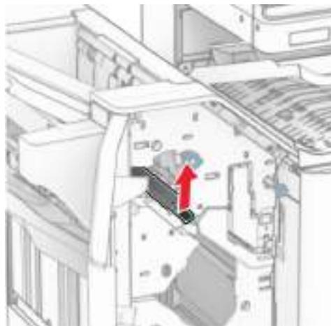
**11** Поверните ручку R3 против часовой стрелки и извлеките замятую бумагу из нижнего выходного лотка финишера.
