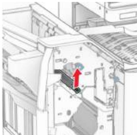
**9** Поверните ручку R3 против часовой стрелки и извлеките замятую бумагу из нижнего выходного лотка финишера.
