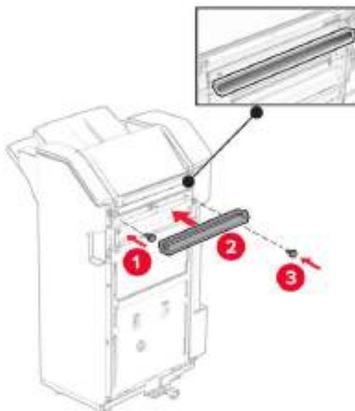
31 Установите нижний выходной лоток финишера и закрепите его винтом.
